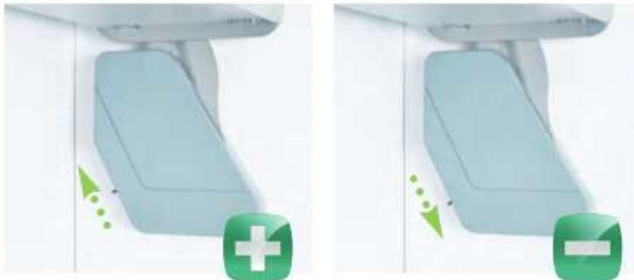
Zum Erreichen der untersten Beladungposition muss der Nutzer den Beschlag über einen Widerstand hinausschwenken. Dadurch rastet der Beschlag ein und bleibt in der Halteposition stehen. Im Auslieferungszustand befindet sich diese Einstellung auf dem leichtesten Niveau. Sollte sich das umgeladene Tablett aus der Haltefunktion lösen, kann der Nutzer die Haltekraft über den Schalter erhöhen. Durch die Verstellung dieses Hebels wird nicht die mögliche Zuladung verändert.
